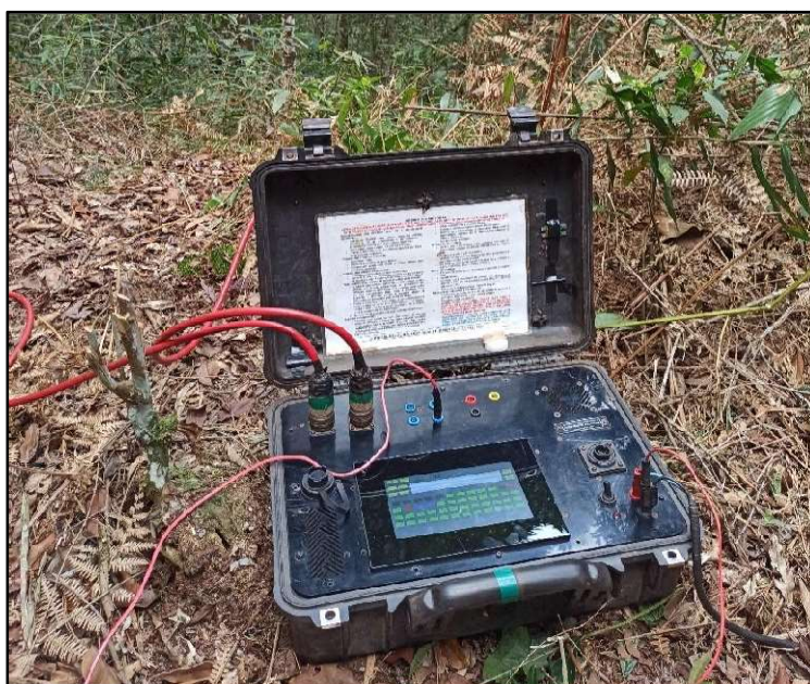
Figura 1 – Resistivímetro ABM AL-48.
