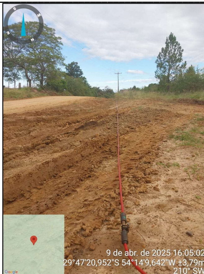
Fotografia 3 – Cabo com os eletrodos receptores de corrente elétrica com passo de 5m.
